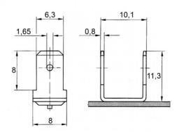
MATERIALE / MATERIAL : Acciaio 4.8 Ramato / Steel 4.8 Copper Plated
