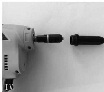
III. Svitare la testa (1) della rivettatrice (3). Estrarre dalla testa (1) il porta morsetti (2) e i morsetti (4). Sostituire i morsetti nel caso in cui siano consumati. Inserire i morsetti nuovi nel portamorsetti. Inserire il porta morsetti nella testa.
